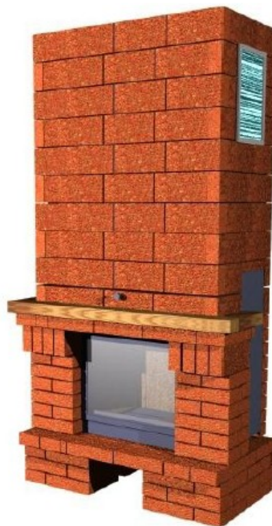
Ukázka obezdění vložky s umístěním PTZ
